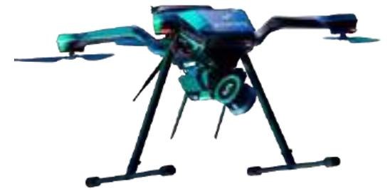
Drone com LiDAR
