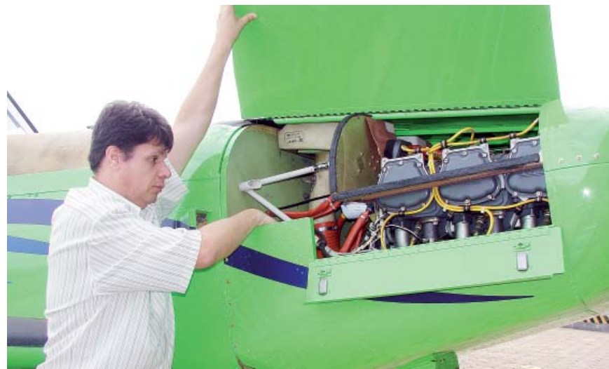
Vicente Camargo, da Engenharia da Embraer, mostra o motor Lycoming adaptado ao etanol.
