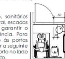
BANHEIRO DO TÉRREO COM ÁREA DE APROXIMAÇÃO INADEQUADA
